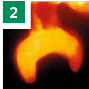
Рожковый ключ при закаливании в масле
