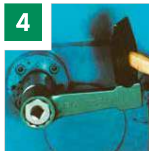
Ударные накидные ключи STAHLWILLE № 8 с двойным шестигранником сильнее, тоньше и выше.
